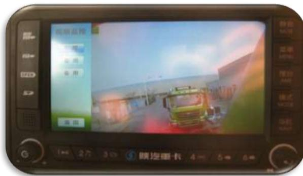
1.5 上述各种画面显示方式，雷达探测信息始终显示。雷达信息包括雷达方位示意图标“←”“→”和障碍物距离信息。若有障碍物接近雷达探头 2 米以内时，显示屏上开始显示雷达探测信息。
