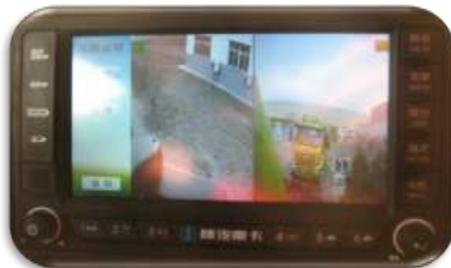
1.4 左转向时，显示屏自动切换、全屏显示车辆左侧摄像头的影像信息；
