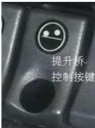
控制提升功能的翘板开关示意图
