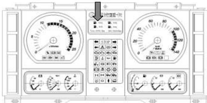
当车辆只安装一个气瓶时， $10\% \leq \text{液量值} \leq 20\%$ ，液量指示灯亮，蜂鸣器报警5s，直到液量  $\geq 23\%$ ，液
