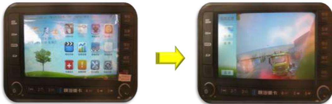
1.2 挂倒车档时，显示屏自动切换、全屏显示车辆后方摄像头的影像信息；
