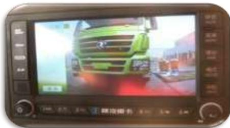
1.3 右转向时，显示屏自动切换、全屏显示车辆右侧摄像头的影像信息；
