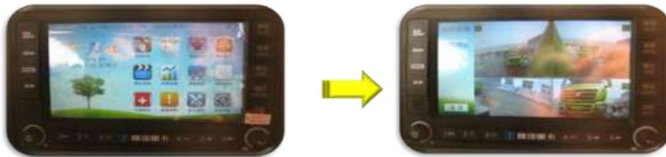
1.2 挂倒车档时，显示屏自动切换、全屏显示车辆后方摄像头的影像信息；
