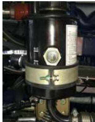
**注 意：**补油必须使用相同种类的液压油，并要特别注意不允许使脏物和尘土进入转向油罐内。
