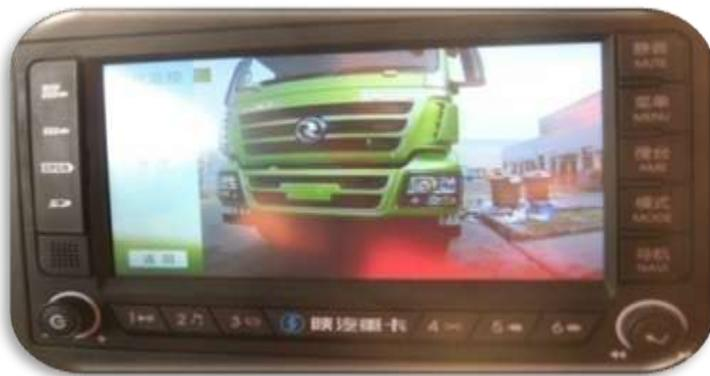
1.3 右转向时，显示屏自动切换、全屏显示车辆右侧摄像头的影像信息
