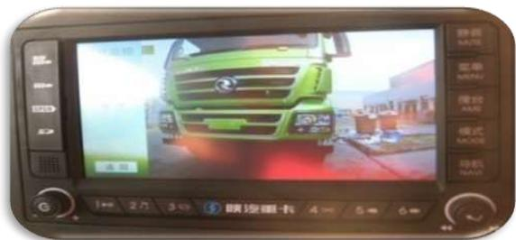
1.3 右转向时，显示屏自动切换、全屏显示车辆右侧摄像头的影像信息；
