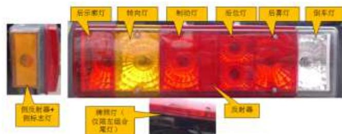
**位置：** 安装在后轮挡泥板上方尾灯支架上(左右对称)。
