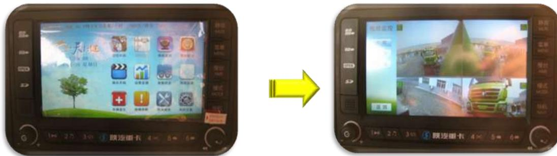
1.2 挂倒车档时，显示屏自动切换、全屏显示车辆后方摄像头的影像信息；
