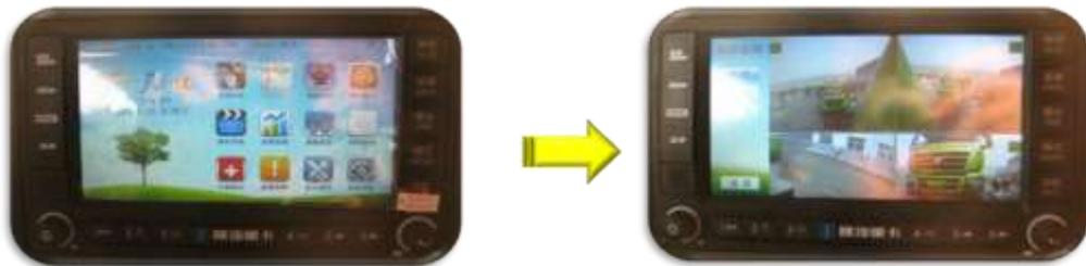
1.2 挂倒车档时，显示屏自动切换、全屏显示车辆后方两路摄像头的影像信息；
