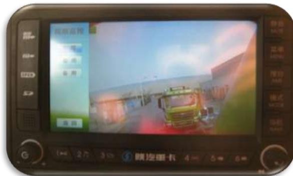
1.5 上述各种画面显示方式，雷达探测信息始终显示。雷达信息仅有障碍物距离信息。若有障碍物接近雷达探头 2 米以内时，显示屏上开始显示雷达探测信息。
