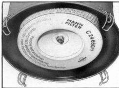
轻轻抽出主滤芯，用压力不高于 500kPa 的干燥压缩空气，沿斜角交叉方向吹净滤芯内、外表面。最好由内向外吹。并擦净密封端面。
