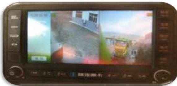
1.4 左转向时，显示屏自动切换、全屏显示车辆左侧摄像头的影像信息；
