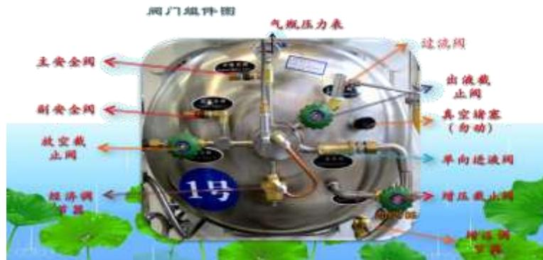
LNG 气瓶端部阀门组件图
