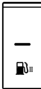
油箱切换开关
