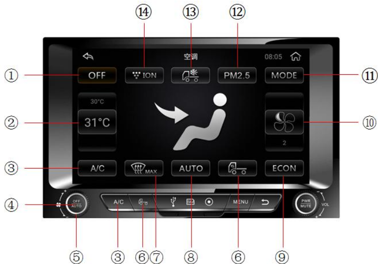
空调控制面板操作界面
